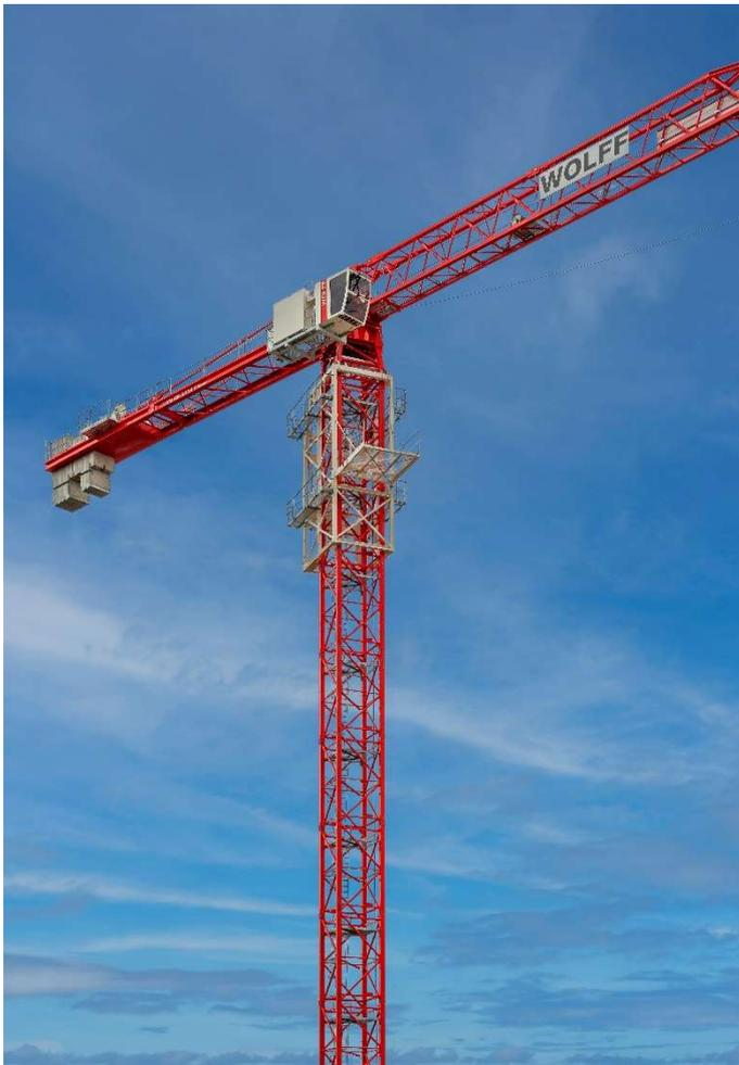
Das Auslegerdesign wird seit Jahren kontinuierlich weiterentwickelt. Der WOLFF 8038 Clear verfügt nicht nur über die funktionale neue Obergurtverbindung mit Stecksystem, sondern auch über eine vereinfachte Untergurtkonstruktion, die mit weniger Material auskommt und damit weniger Montagegewicht mitbringt.
