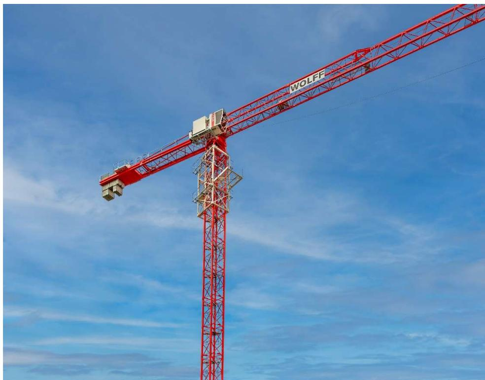
Der WOLFF 8038 Clear vereint die Leistungsfähigkeit eines Turmspitzenkrans mit den Montagevorteilen der spitzenlosen Bauweise. Für Klettertests ist er hier auf dem Testgelände mit einem Außenkletterwerk zu sehen.
