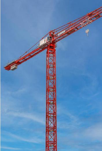
Der WOLFF 8095 Compact ist Wolffkrans bisher größter Laufkatzkran. Er tritt in der 900-mt-Klasse mit reduzierter Turmspitze an. Dadurch kann er sowohl bei den Traglasten als auch bei der Montage punkten.
