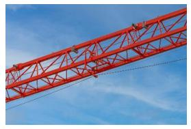
Durch die Konstruktion der ersten drei Auslegerteile als Vier-Gurt- statt als Drei-Gurt-Variante können deutlich höhere Traglasten erreicht werden. Die Hubseilunterstützung am Ausleger reduziert den Seildurchhang von sieben auf nur noch 1,5 Meter und macht das Arbeiten mit mehreren Kranen sicherer.
