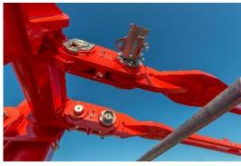
Erleichterungen bei der Montage bringen die Abstützungen für die Gegenauslegermontage (I.) und die Bolzendepots (o.).
