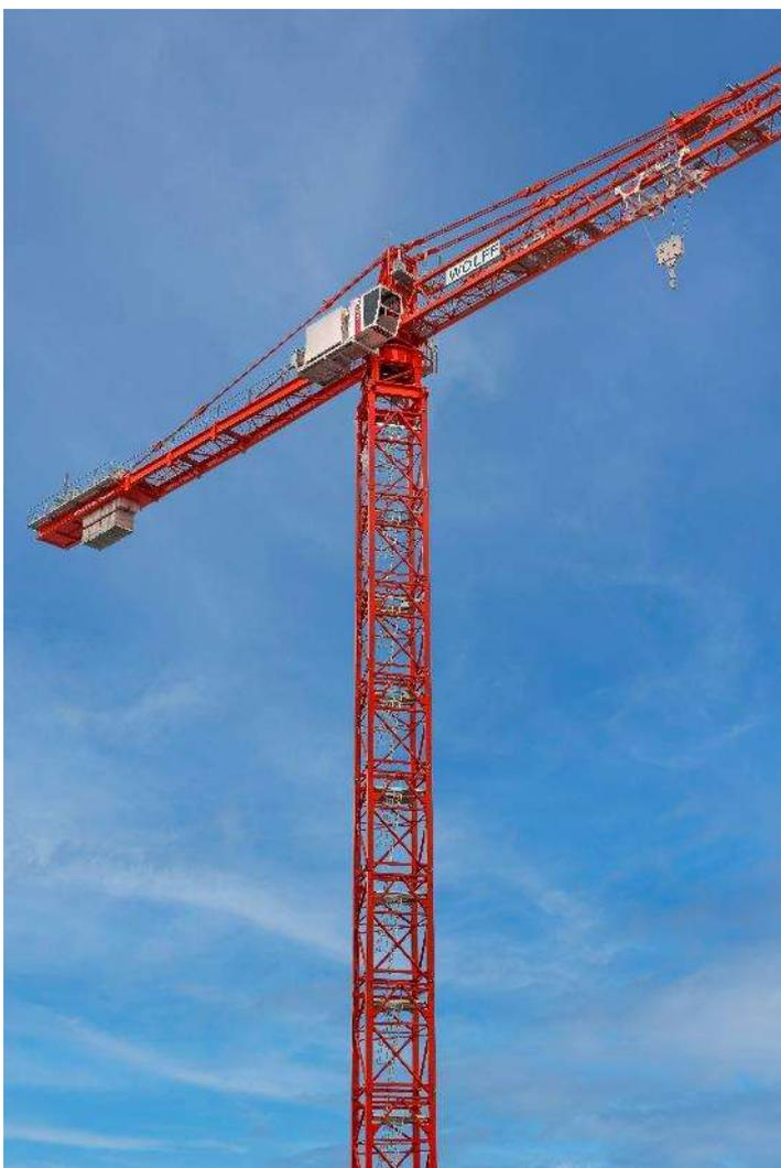
La WOLFF 8095 Compact est la plus grande grue à flèche horizontale jamais conçue par Wolffkran. Elle entre dans la catégorie des 900 mt avec encombrement réduit au sommet, ce qui lui confère à la fois une capacité de levage exceptionnelle et un montage optimisé.
