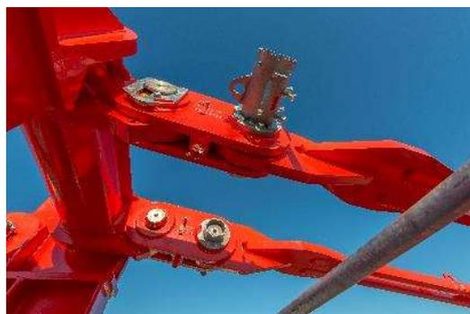
Le montage est facilité grâce aux supports dédiés à l'installation de la flèche et au rangement des axes.
