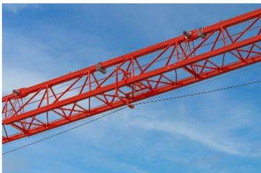
En concevant les trois premières sections de flèche avec une structure à quatre longerons au lieu de trois, la transmission des forces dans la flèche a été optimisée. De plus, l'allègement de certains composants permet d'atteindre des capacités de levage nettement supérieures.
