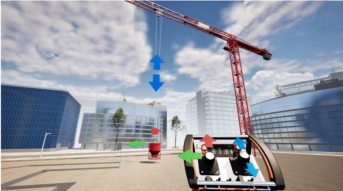
WOLFF Intuitive Control übernimmt die komplexe Koordinatentransformation automatisch und erlaubt es dem Bediener, die Last direkt in die gewünschte Richtung zu steuern. Für mehr Komfort und Sicherheit auf der Baustelle.
